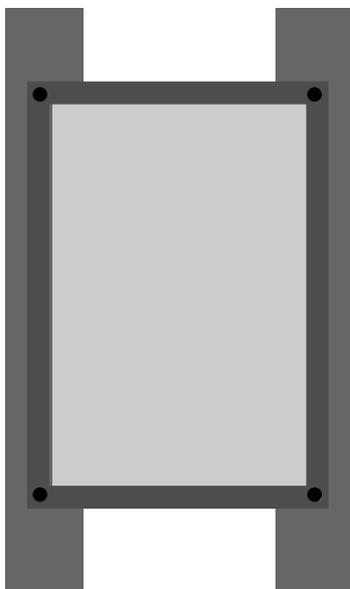
Rahmen 2 ist nach innen etwas breiter als Rahmen 1 und sichert somit, dass die Bildplatte nicht aus dem Rahmen fallen kann. Beide Rahmen werden übereinander gelegt, Durch das Vernieten mit dem Rohr an 4 Punkten werden Bildplatte und beide Rahmen press am Rohr anschließen. Der Vorteil ist, dass die Original-Bildplatte nicht durchbohrt werden muss, sondern einfach nur von den beiden Rahmen gehalten wird.
